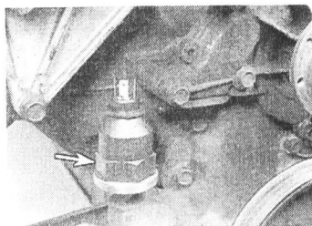
Рис. 2.4а. Датчик давления масла на двигателе 3,8 л расположен в верхней части корпуса масляного фильтра (показан стрелкой). Для проверки давления масла снять датчик...
