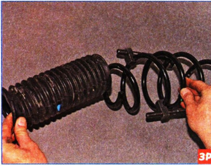
Разъединяем пружину и защитный чехол.
