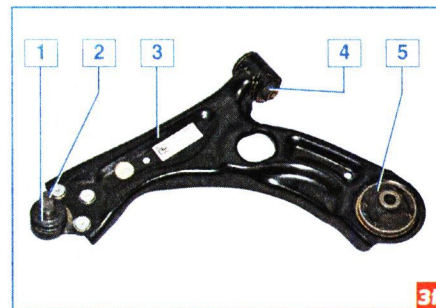
Рычаг передней подвески с шаровой опорой: 1 – чехол шаровой опоры; 2 – палец шаровой опоры; 3 – рычаг; 4 – сайлент-блок переднего крепления рычага к подрамнику; 5 – сайлент-блок заднего крепления рычага к подрамнику
