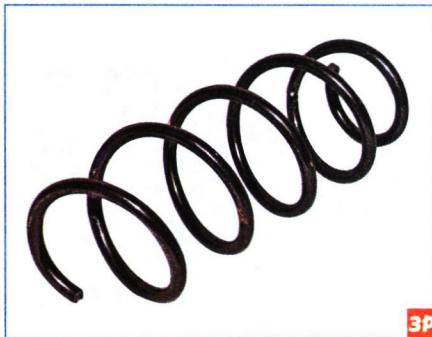
Диаметры нижнего и верхнего витков пружины разные. Диаметр нижнего витка больше, чем верхнего.
