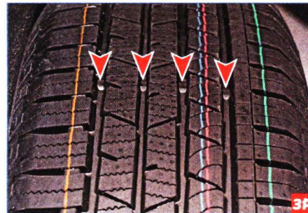
Для контроля износа протектора в его канавках выполнены индикаторы в виде выступов высотой 1,6 мм.
