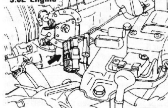
Рисунок 44.6 а Для присоединения тахометра на модели с инжекцией топлива, определите местоположение конектора топливного инжектора (указан стрелкой) ...
