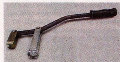
**12. Приспособление** для снятия шаровых опор.
