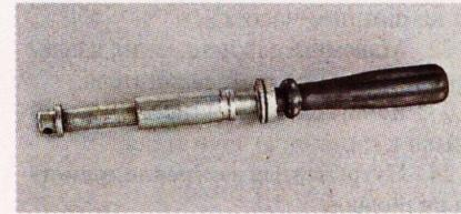
**14. Приспособление** для выпрессовки и запрессовки сайлент-блоков рычагов передней подвески.
