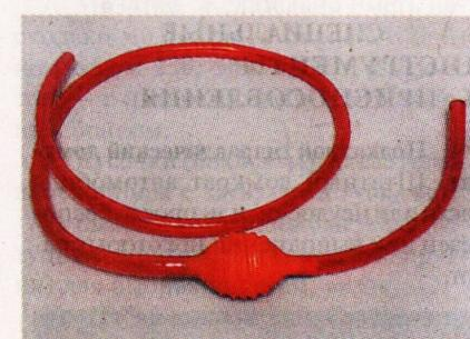
**37. Медицинский шприц** или груша для отбора жидкостей (например, при необходимости снятия бачка главного тормозного цилиндра без слива всей тормозной жидкости из системы). Шприц также незаменим для чистки деталей карбюратора.
