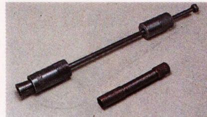
**11. Рассухариватель** для разборки клапанного механизма головки блока цилиндров.
