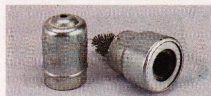
**34. Масляный шприц** для заливки масла в коробку передач и задний мост.
