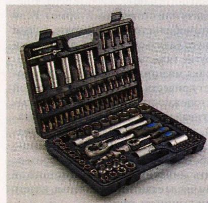
**2. Вороток с шарниром и длинной ручкой.** Он необходим для отворачивания резьбовых соединений большого диаметра, когда необходимо приложить значительные усилия.
