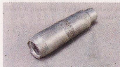
**31. Оправка для обжима поршневых колец при установке поршня в цилиндр.**
