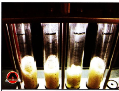
Очевидно, что топливная форсунка в третьем мерном цилиндре подает топлива меньше, чем остальные форсунки.
