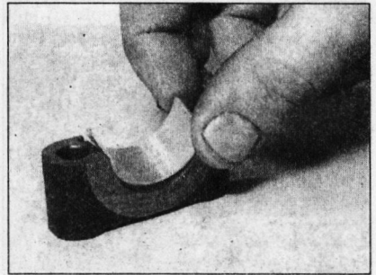
11.19а Установка верхнего вкладыша распредвала в крышку
