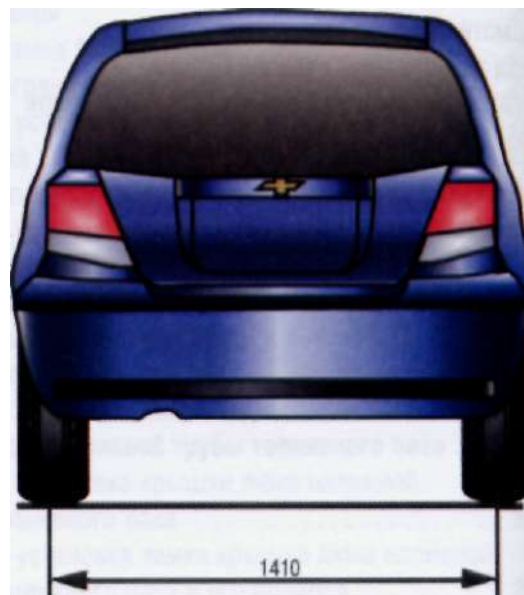
Рис. 1.1. Габаритные размеры автомобиля (в скобках указаны отличительные размеры автомобиля с кузовом седан)
